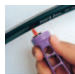
Einsetzen von Xeri-Bug™ in einem Schritt
