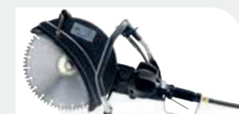
DRUCKLUFT-ANTRIEB HUSQVARNA K400 7 kp/cm 2 , 3,2 kW, 9,9 kg, Scheibendurchmesser 350 mm, Schnitttiefe 125 mm.
