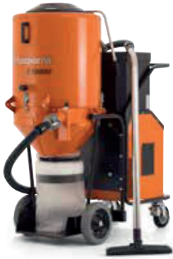
ELEKTRO-ANTRIEB HUSQVARNA T10000 11 kW, 380 – 415 V, 32 A, 900 m³/Std, 336 kg.
