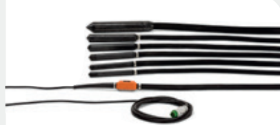
ELEKTRO-ANTRIEB HUSQVARNA AX BETONRÜTTLER 42 V-3-200 Hz, Ø 36 – 90 mm, Schlauchlänge 5, 8, 10 m, 13,1 – 18,8 kg.
