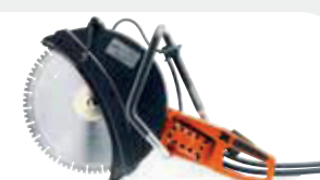
HYDRAULIK-ANTRIEB HUSQVARNA K 2500 150 bar / 40 l/min, 5,2 kW, 8,3 kg, Scheibendurchmesser 400 mm, Schnitttiefe 145 mm.
