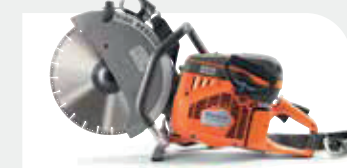
BENZIN-ANTRIEB HUSQVARNA K970 RESCUE 94 cm 3 , 4,8 kW, 11 kg, Scheibendurchmesser 350 mm, Schnitttiefe 125 mm.
