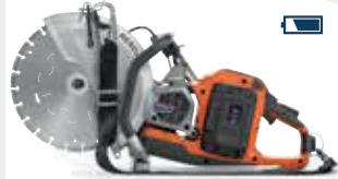
AKKU-ANTRIEB HUSQVARNA K1 PACE RESCUE 7,9 kg, Scheibendurchmesser 350 mm, Schnitttiefe 145 mm. PACE 94V-Akku-System.
