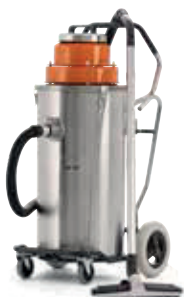
ELEKTRO-ANTRIEB HUSQVARNA W70 P 1,2 kW, 220 – 230 V, 8 A, 200 m³/Std, 44 kg.
