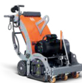
ELEKTRO-ANTRIEB HUSQVARNA BMC 335 16 kW, 400V/ 32- 63 A, dreiphasig, 335 mm Arbeitsbreite, 430 kg.
