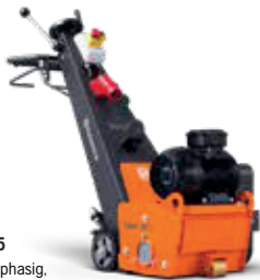
ELEKTRO-ANTRIEB HUSQVARNA BMP 4000RC Fernsteuerung, 30 kW, 400V/63 A, dreiphasig, 400 mm Arbeitsbreite, 1550 kg.
