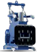
ELEKTRO-ANTRIEB HUSQVARNA BLASTRAC EBE 200VMB 7,5 kW, 400 V, 32 A, Arbeitsgeschwindigkeit 0,2 – 20 m/min, Arbeitsbreite 217 mm, 177 kg.
