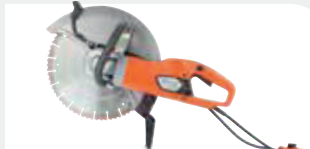
ELEKTRO-ANTRIEB HUSQVARNA K 4000 230/120/110 V, 2700/1800/2200 W, 8,5 kg (inkl. Absaugaufsatz 1 kg), Scheibendurchmesser 350 mm, max. Schnitttiefe 125 mm.
