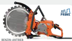
BENZIN-ANTRIEB HUSQVARNA K 7000 RING 230/400 V, 5,5 kW (dreiphasig) / 3 kW (einphasig), 13,1/ 12,4 kg, Scheibendurchmesser 350/425 mm, Schnitttiefe 270/325 mm.
