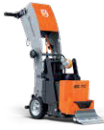
ELEKTRO-ANTRIEB HUSQVARNA BS 110 1,5 kW, 230V/16 A, 170 kg.
