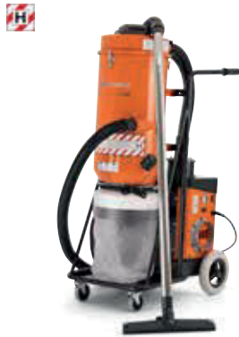
ELEKTRO-ANTRIEB HUSQVARNA S36 3,6 kW, 220 – 230 V, 14 A, 600 m³/Std, 65 kg.
